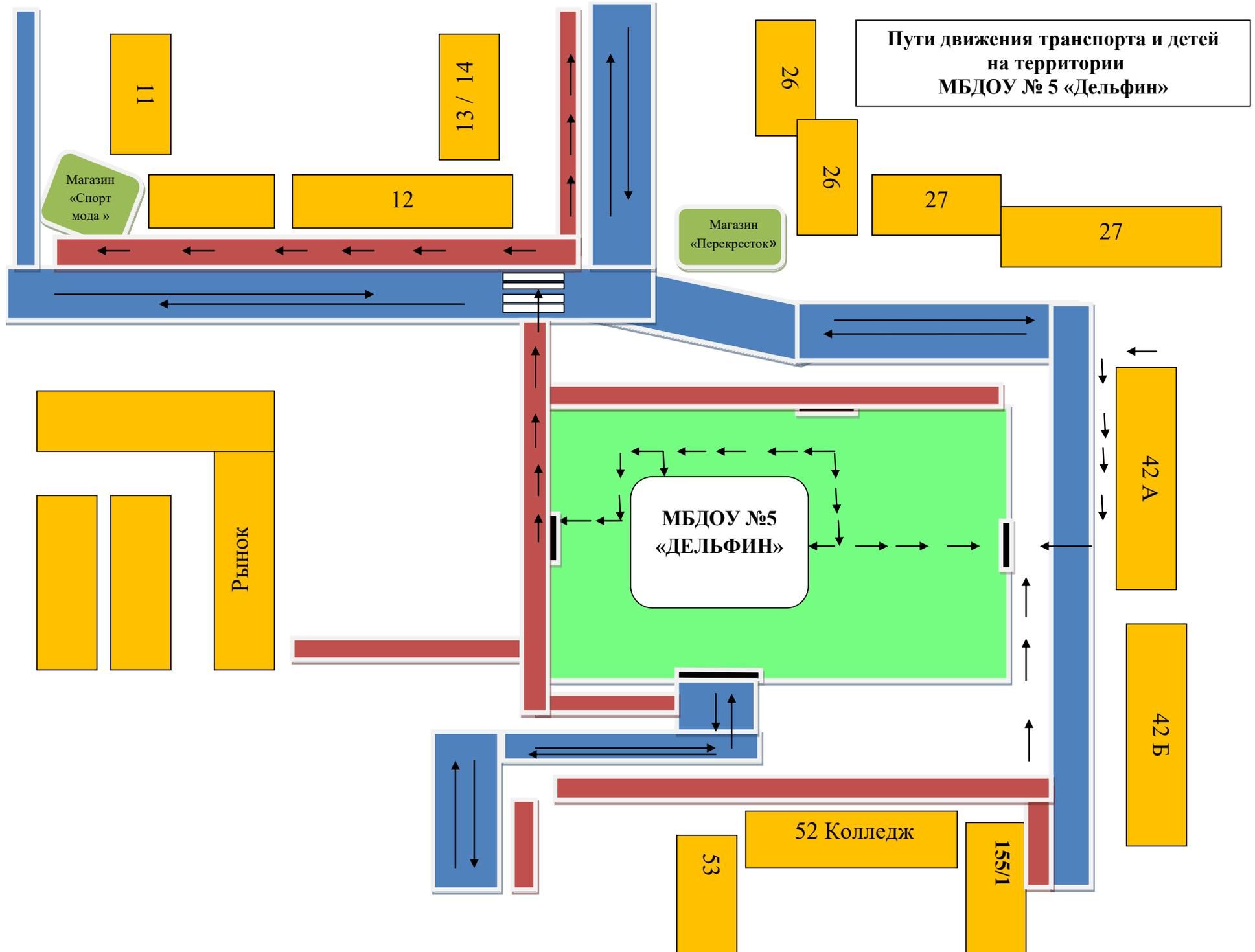
План – схема пути движения транспортных средств и детей при проведении дорожных ремонтно-строительных работ
